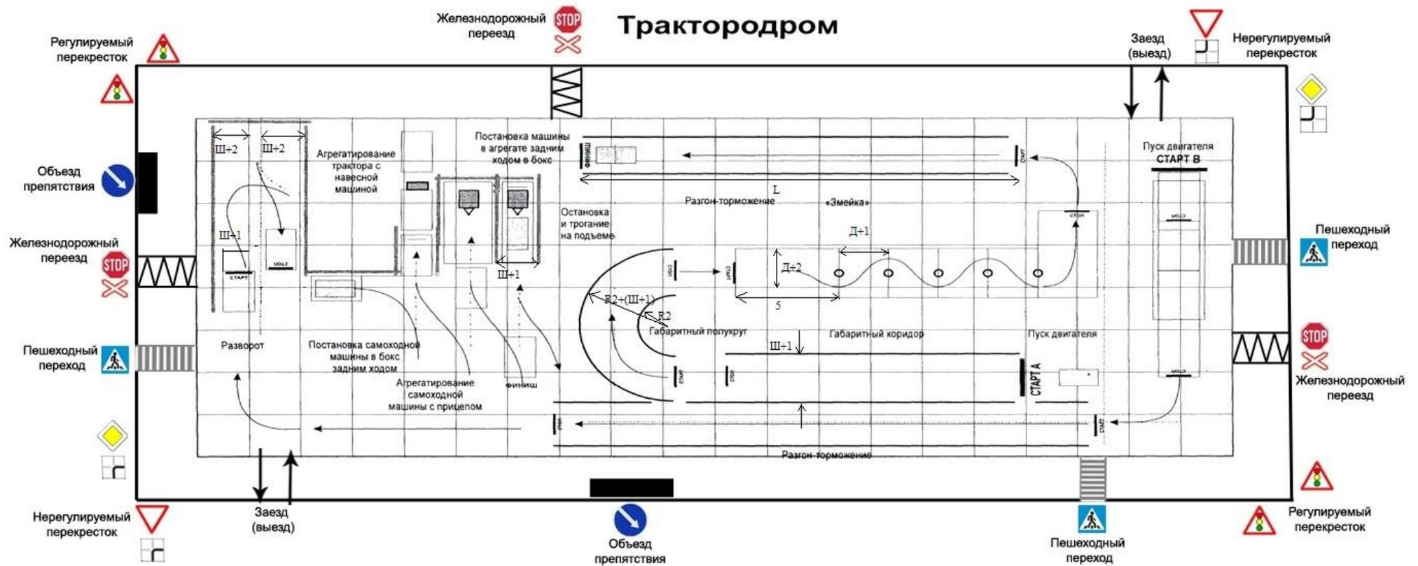
1. Габаритный коридор габаритный полукруг, разгон-торможение: Ш - ширина самоходной машины.
